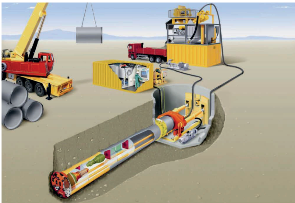
Schema Microtunneling (Quelle: Herrenknecht)
