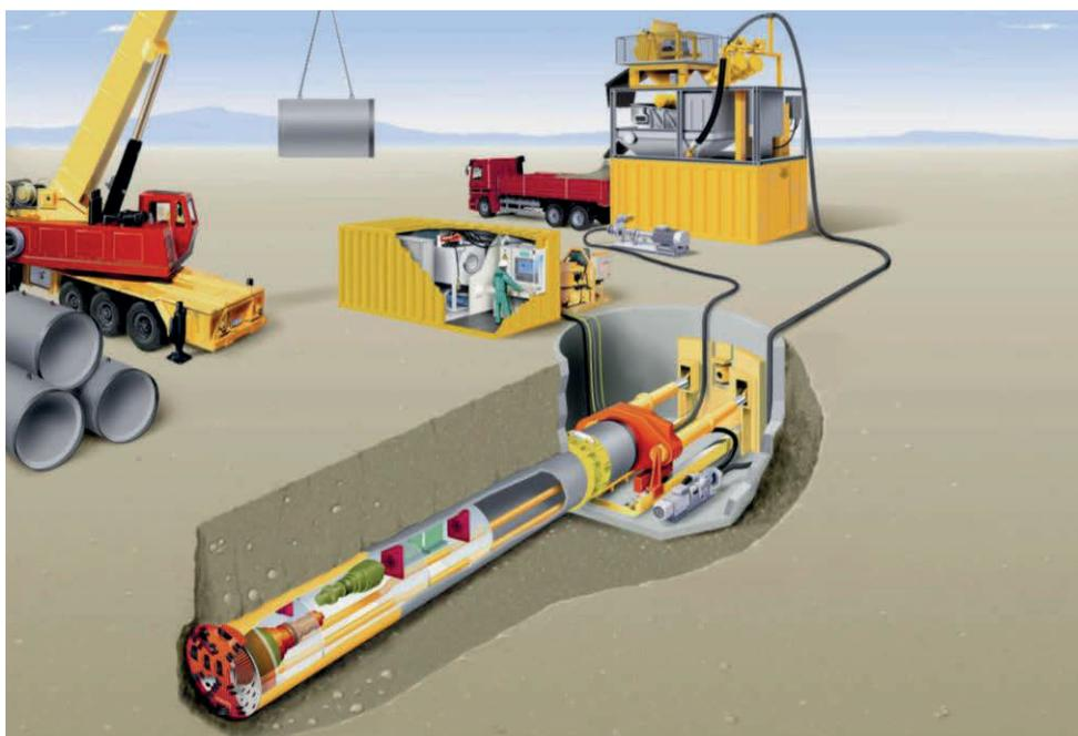
Schéma de microtunnelage (source : Herrenknecht)
